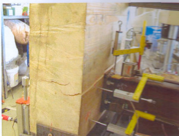
obr. 2.13: Porušenie dreveného bloku priečnym ohybom
