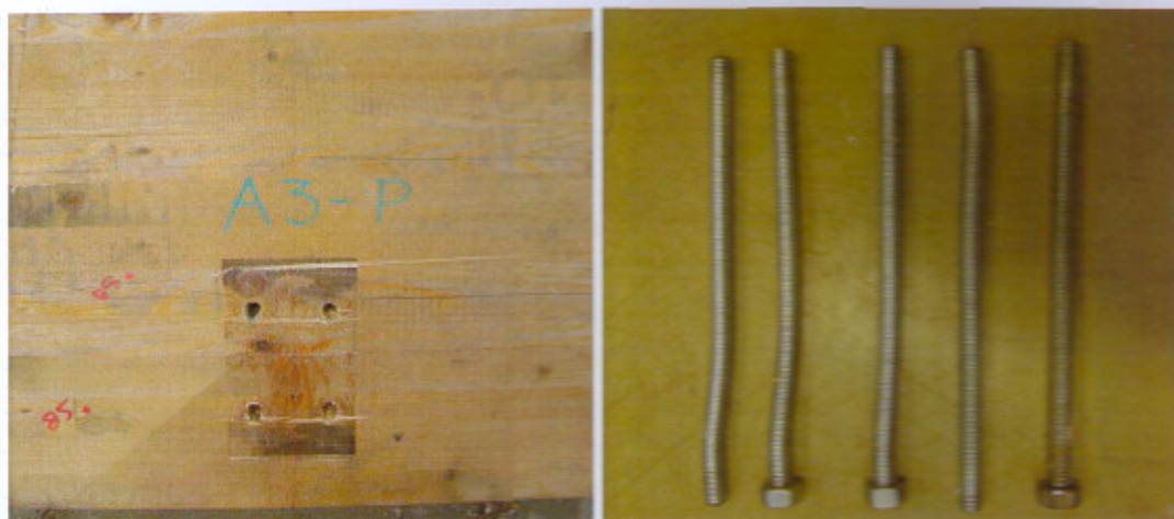
obr. 2.12: Porušenie prípoja otláčením steny otvoru, pohľad na deformované svorníky
